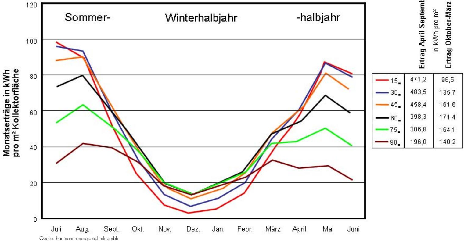
Kollektorertrag bei fester mittlerer Kollektortemperatur von 40°C in kWh/m²; Standort Stuttgart
