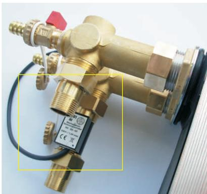
Der Strömungsschalter muss nach **UNTEN** abgehen, da sonst der integrierte Schwimmer **NICHT** schaltet.
